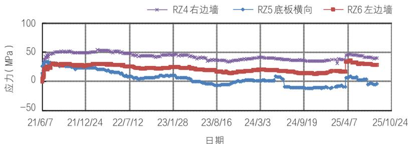
图5 狮子山隧洞DLII46+910监测断面钢筋典型应力-时间过程曲线
